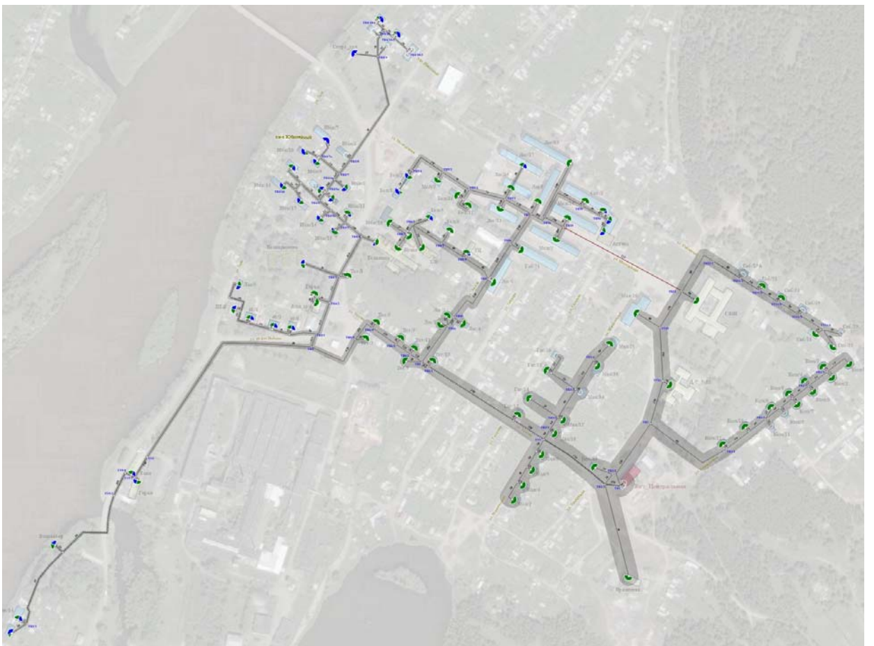
Рис. 1.3. Качественная оценка пропускной способности участков тепловой сети от котельной «Центральная» п. Мишелевка. (А – расчет без регуляторов, Б – расчет с регуляторами)
